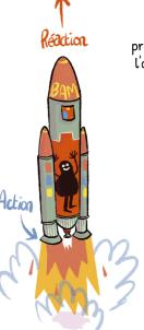
Les fusée spatiales utilisent ce même principe d'action-réaction pour s'arracher à l'attraction terrestre en éjectant une très grande masse de gaz enflammé.
